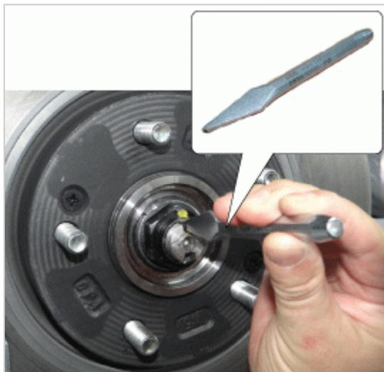
如果螺母末端上有螺纹(A)，使用凿子撬开锁片，然后拧下轮毂螺母，以防止损坏驱动轴螺纹。
