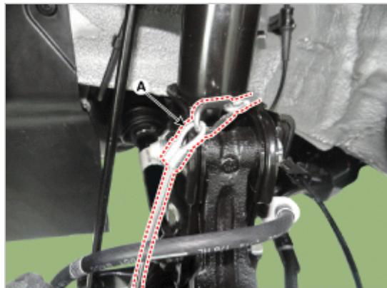
在前减振器上绑住保护钢索，以防止专用工具掉落和伤害操作人员。
