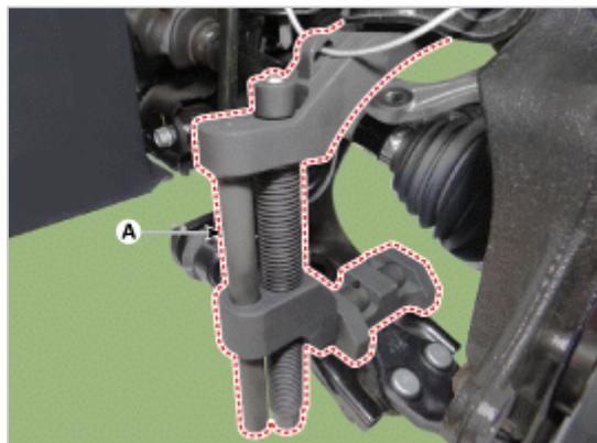
(6) 为防止主支架脱落，在主支架旁边安装固定夹钳 (A)。
